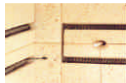
Platin-Rhodium - Thermoelement zur Temperaturerfassung bruchsicher geschützt
